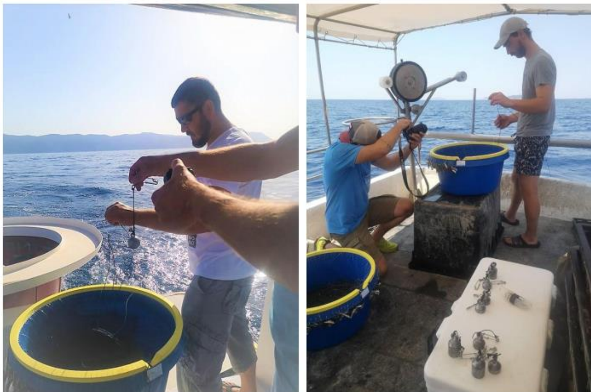
Slike 5 i 6. Testiranje dodatnog otežanja (utega) na stajaćim parangalima
