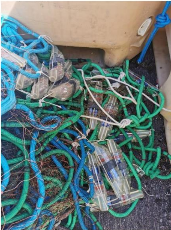
Slike 3 i 4. Testiranje LED lampica na mrežama stajačicama
