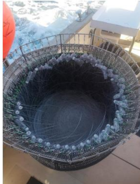
Slike 8 i 9. Testiranje uređaja za oslobađanje udica plutajućih parangala pod morem (hookpodi)
