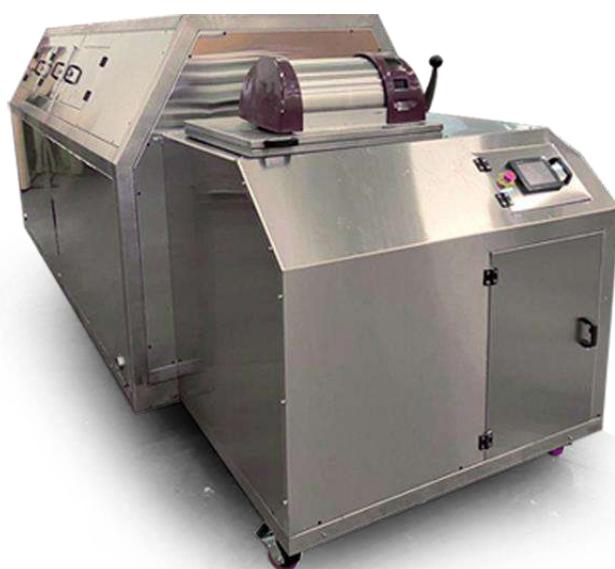
Slika 6. Komposter za decentralizirani sustav zbrinjavanja biootpada (kapacitet 37 tona godišnje)
