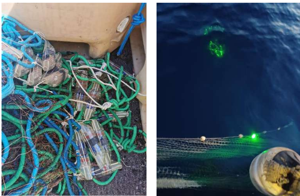
Slika 1. Testiranje LED lampica na mrežama stajaćicama
