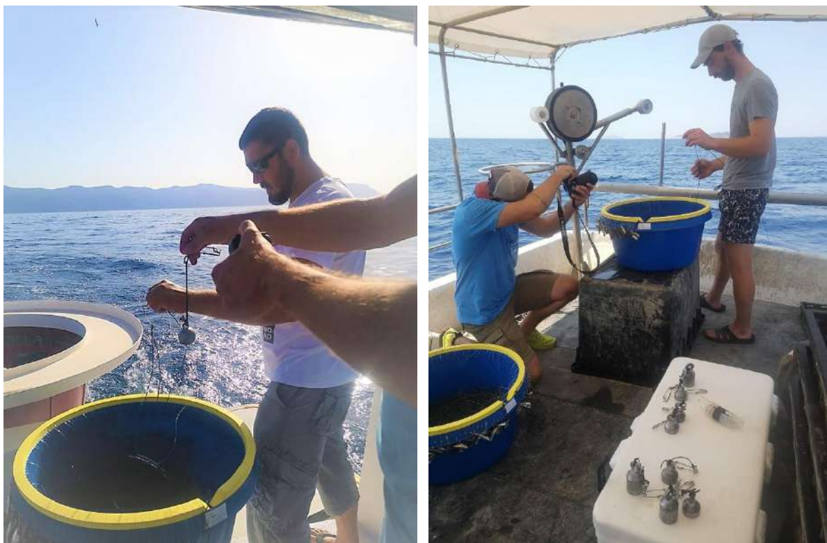
Slika 2. Testiranje dodatnog otežanja (utega) na stajaćim parangalima
