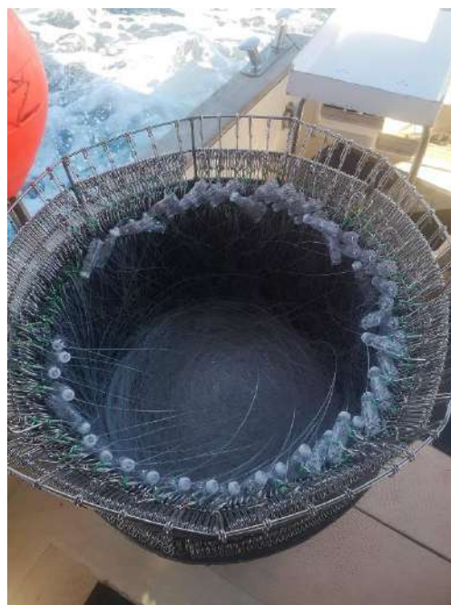
Slika 3. Testiranje uređaja za oslobađanje udica plutajućih parangala pod morem (hookpodi)
