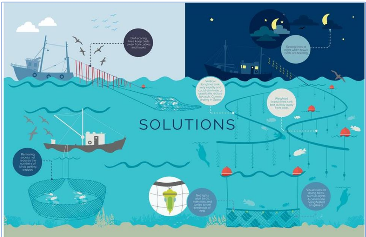
Slika 11 Primjeri različitih mjera za smanjenje slučajnog ulova morskih ptica
